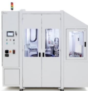
Die Serie SF wurde von OTEC für das Verfahren Streamfinish entwickelt. Beim Streamfinish werden Werkstücke in einen Halter eingespannt und in den sich drehenden, mit Schleif- oder Poliermittel gefüllten, Behälter abgesenkt.
