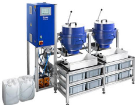
Avec cette machine à force centrifuge vous profitez d'une utilisation simplissime et de résultats de traitement parfaits. Ébavurage, lissage, émerissage et polissage – Tout est possible avec la CF 2x18.
