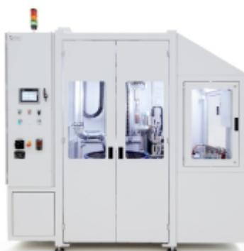
La technologie de polissage à flux continu SF (Streamfinish) ouvre la voie à une nouvelle génération de machines de tribofinition. Ce procédé consiste à fixer les pièces dans un support avant de les plonger dans une cuve en rotation remplie d'abrasifs ou d'agents de polissage.
