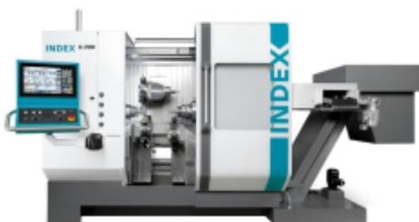
L'INDEX G200.2 est appropriée pour l'usinage complet de pièces, à partir de barres ou de lopins. La zone de travail spacieuse permet de multiples possibilités de tournage-fraisage, pouvant aller jusqu'à 660 mm de longueur de tournage.
