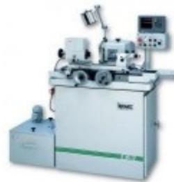
[RC 250](#): Rectifieuse cylindrique manuelle utilisée pour la rectification extérieure et intérieure de pièces jusqu'à 250 mm entre-pointes.
