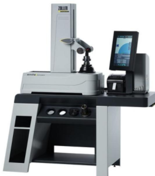
Avec »pilotStarter«, toutes les mesures standard comme les dimensions longitudinales et transversales, les rayons, les angles ainsi que la concentricité et la planéité sont effectuées par simple pression sur un bouton.
