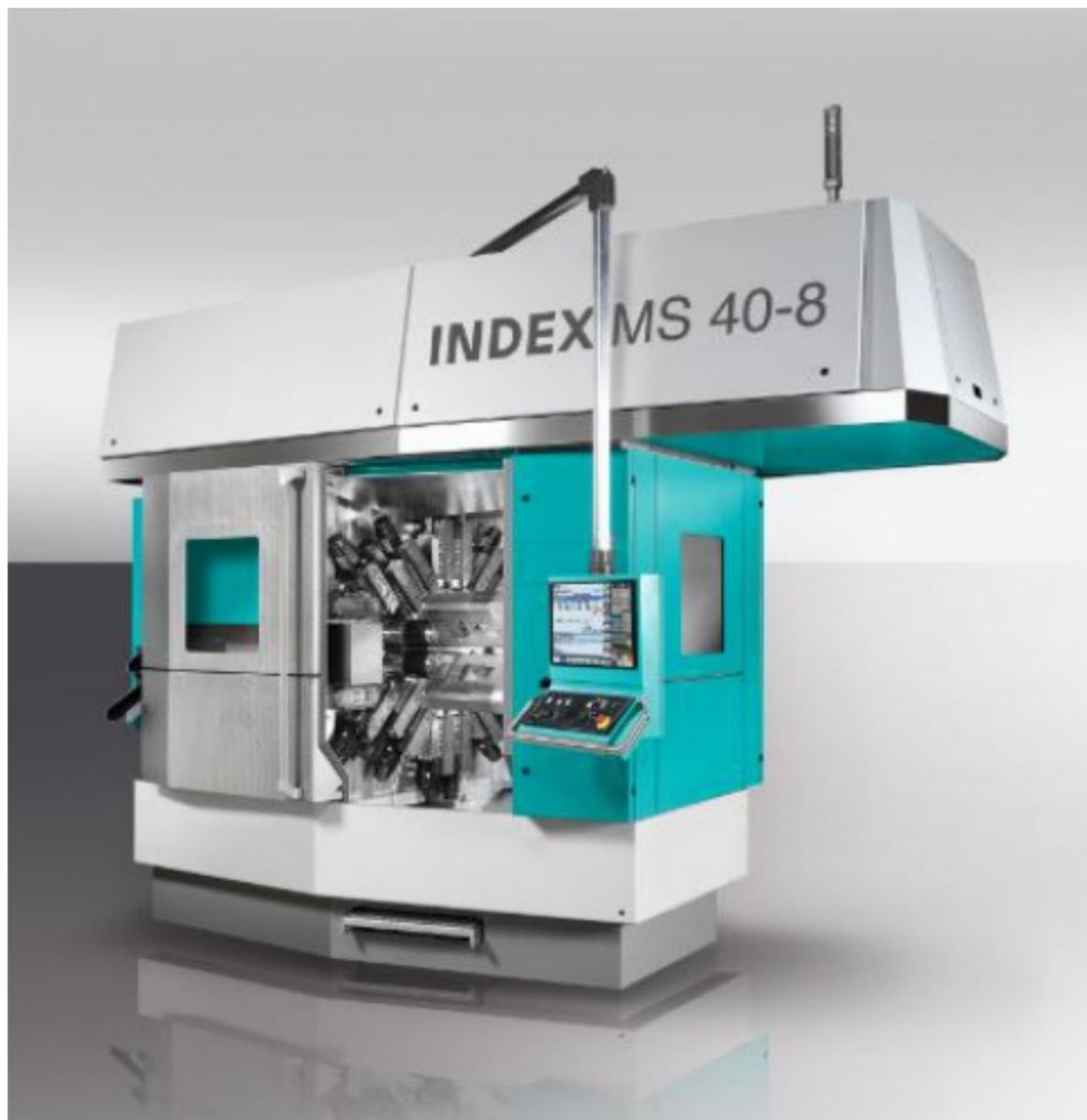
[INDEX MS40C-8](#): Der mit acht Spindeln noch produktivere Mehrspindler für maximale Performance verbindet die Vorteile der CNC-Technik mit den Vorteilen kurvengesteuerter Drehautomaten.
