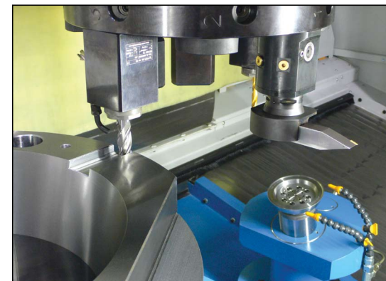
Bild 14: Fräsen einer Horizontalnute
