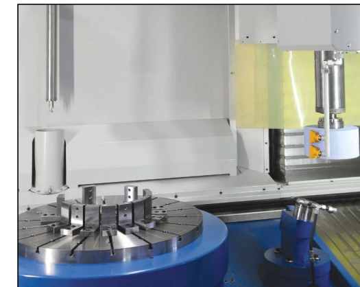
Bild 6: Revolver mit vier Werkzeugplätzen und Messsystem
