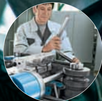
CNC-Rohrbiegemaschine zur Vorkonfektionierung von Edelstahl-Rohrleitungen
