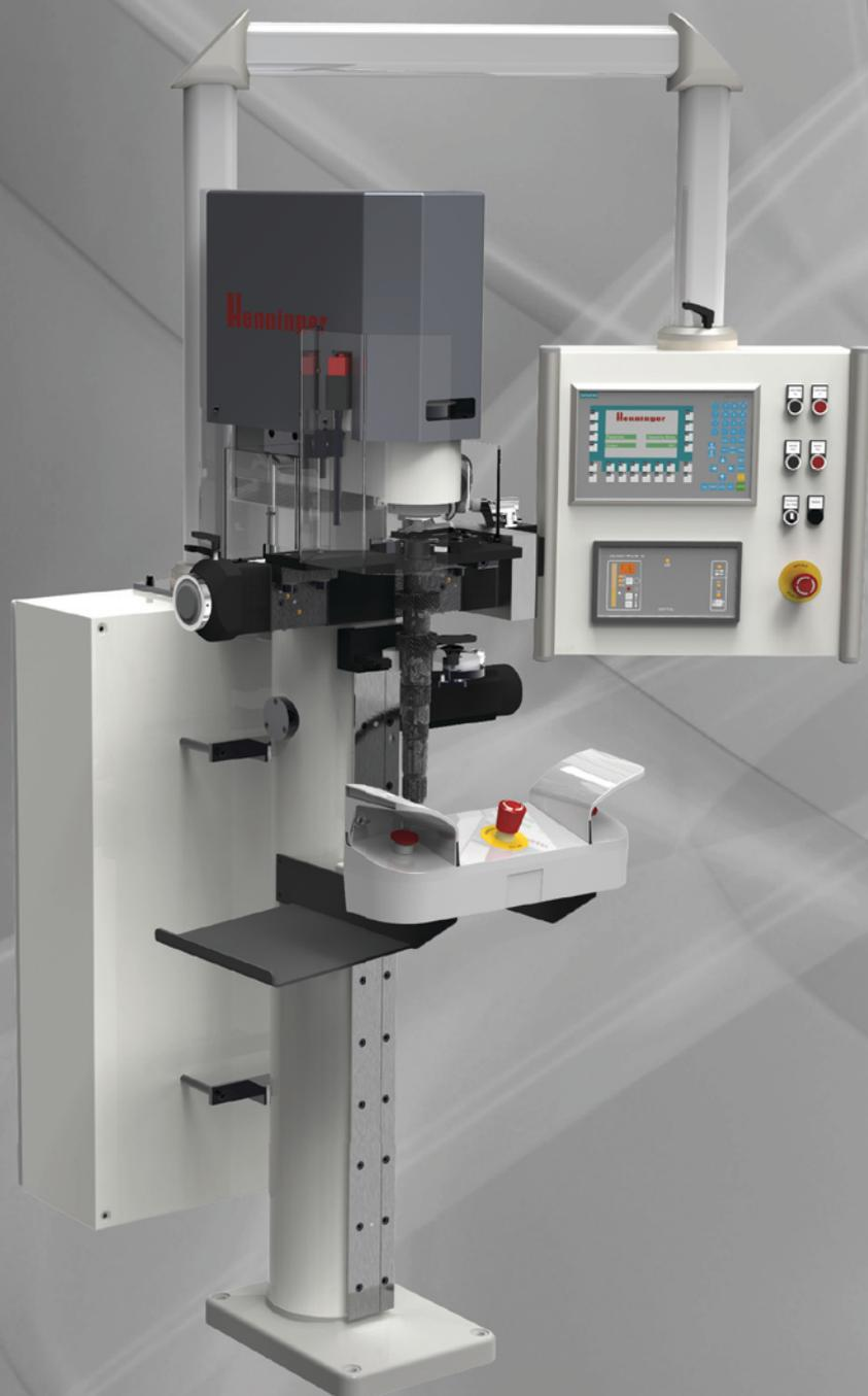
Für Großserien können unsere Zentrum Schleifmaschinen mit einer CNC-Steuerung ausgestattet werden. Für die automatische Bestückung der Maschine kann ein Handling System als Option angeboten werden.
